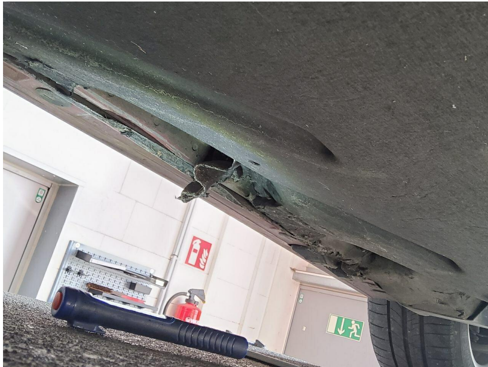
Bild 31 : Unterbodenverkleidung links gerissen
