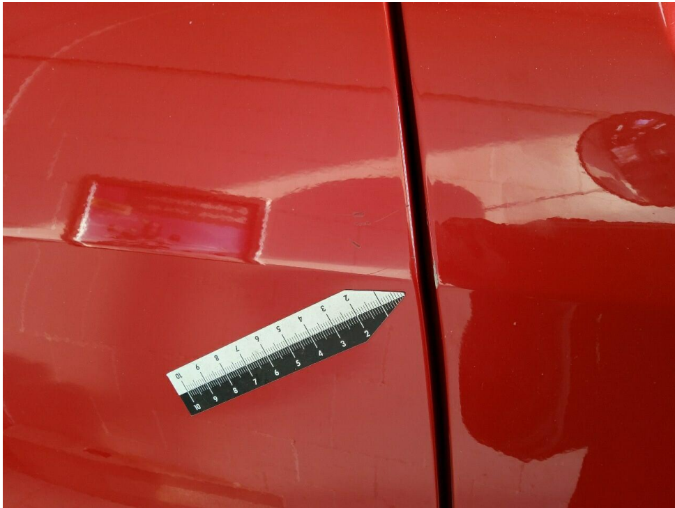
Bild 39 : Tür hinten rechts Kratzer
