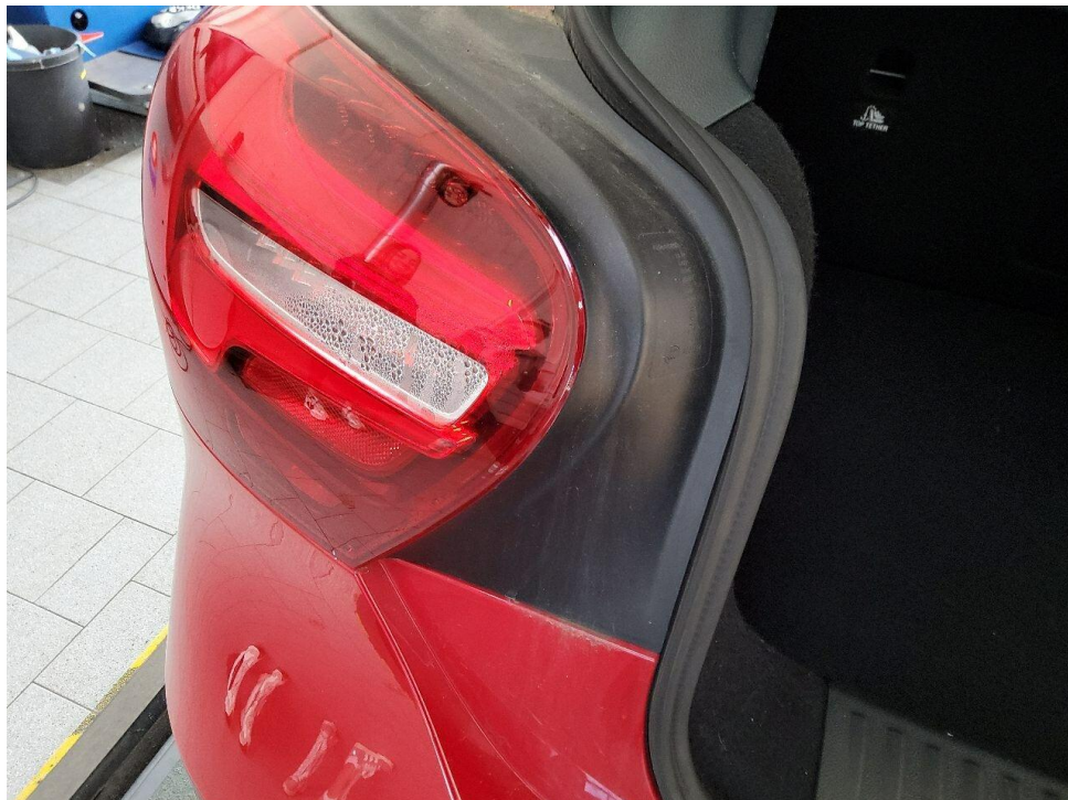
Bild 24 : Heckleuchte links undicht
