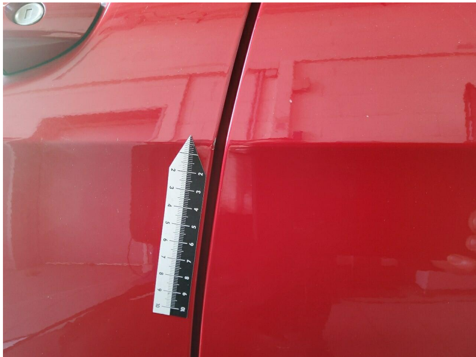
Bild 46 : Tür vorne links Türkante Lackabplatzer
