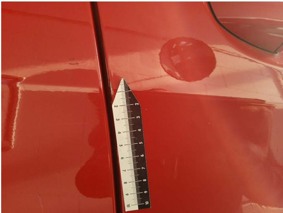
Bild 40 : Tür vorne rechts Türkante Lackabplatzer
