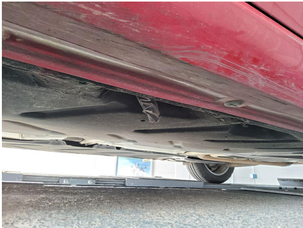
Bild 32 : Unterbodenverkleidung links gerissen
