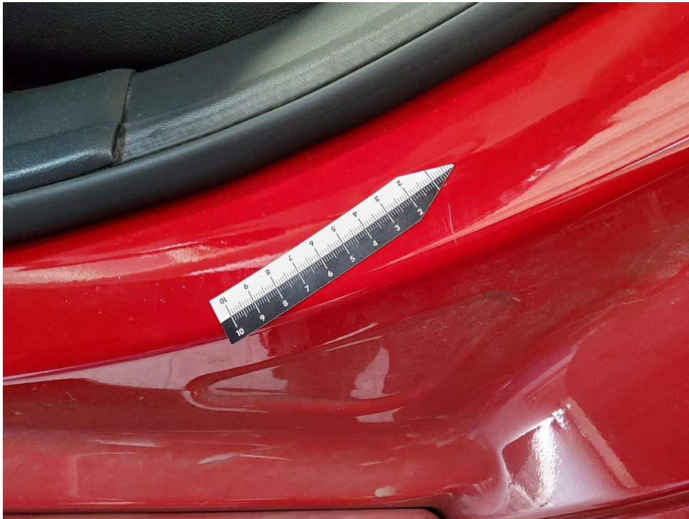
Bild 35 : Einstieg hinten links Kratzer
