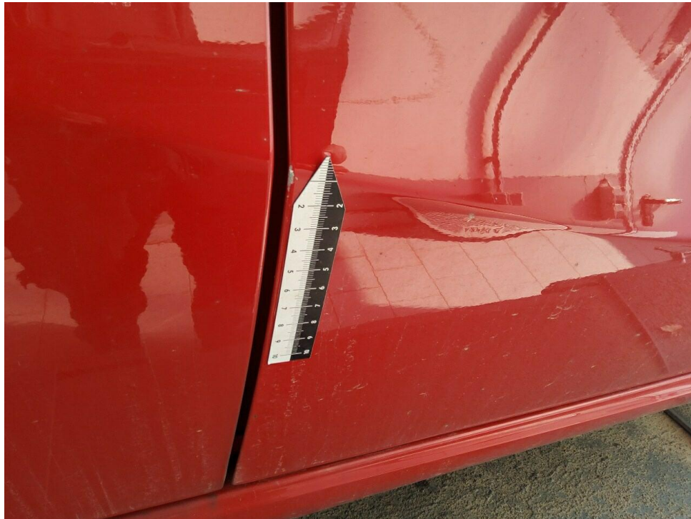
Bild 41 : Tür vorne rechts Türkante Lackabplatzer
