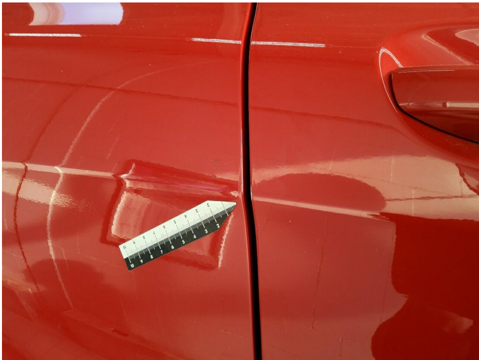
Bild 38 : Tür hinten rechts Kratzer
