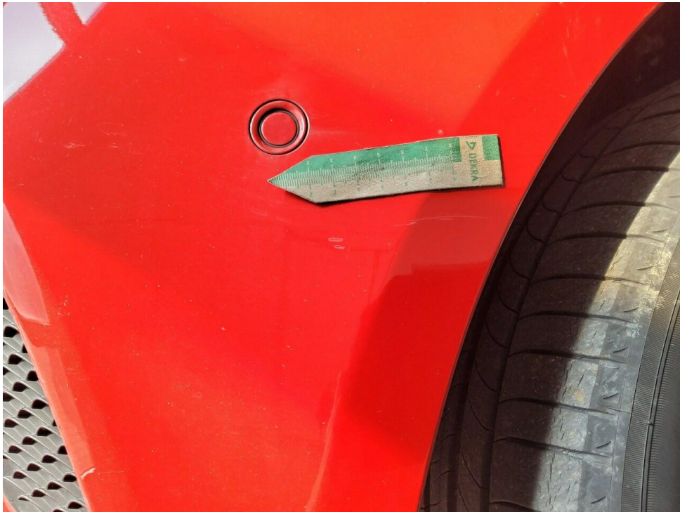
Bild 47 : Frontstoßfänger links Kratzer
