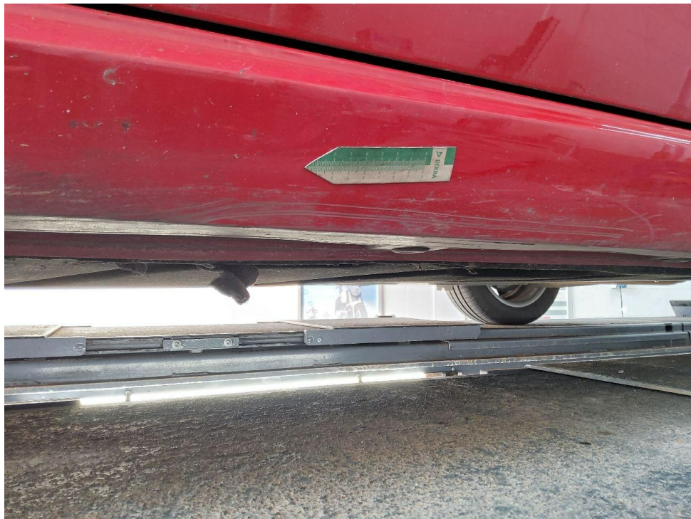
Bild 28 : Schwellerverkleidung links verschrammt
